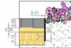
Escocell d'acer galvanitzat anclat a llosa de formigó
