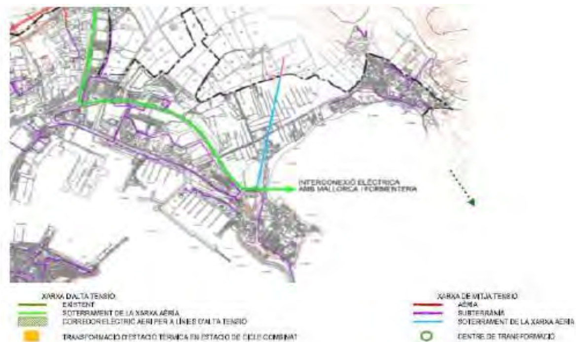
Figura 8. Fragmento del mapa de red eléctrica principal (mapa O.6.3 del PGOU de Eivissa). Nota: Por último, el cable eléctrico con Mallorca no hace su entrada al mar donde se indica con la línea verde continua, sino en el este de la bahía, aproximadamente según indica la línea verde discontinua que se ha añadido.
