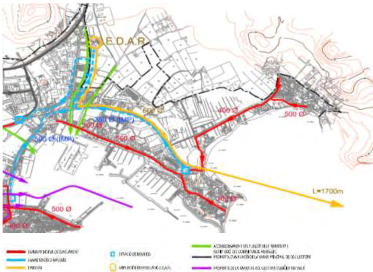
Figura 10. Fragmento del mapa de red principal de saneamiento y pluviales (mapa O.6.2 del PGOU d'Eivissa).
